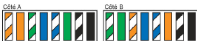
Figure 1 - Ordre des brins du câble croisé.
